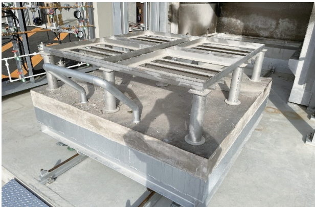
図 6 台車外観（炉外搬出状態）
