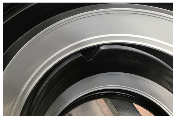
図5 金型成形によるゴム弁座
