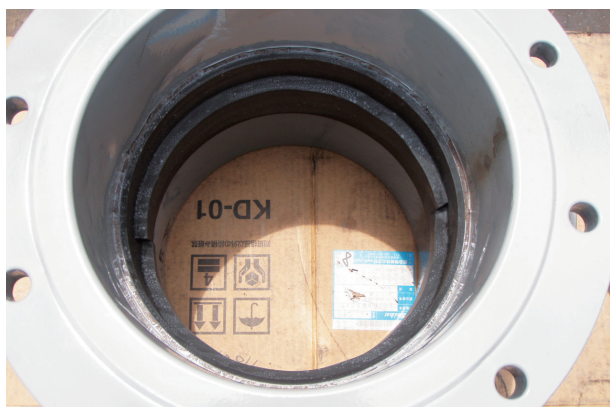
図4 積層技術によるゴム弁座
