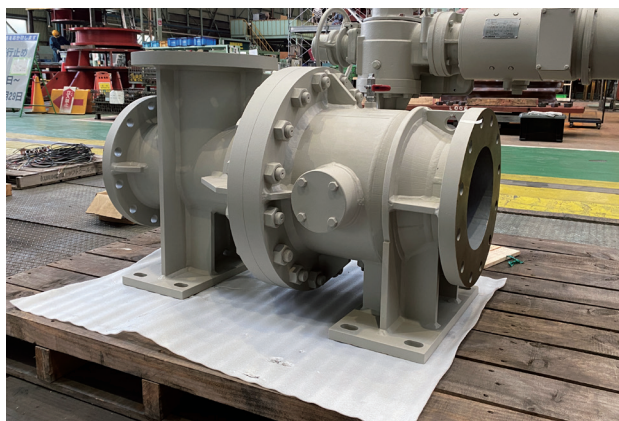
図4 二股発電所／リンクスリーブバルブ
