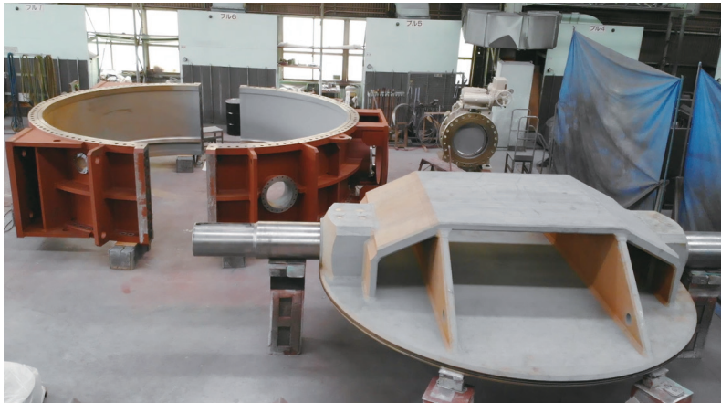
図 4 弁箱の分割構造
