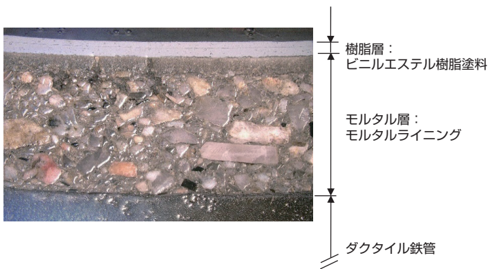
図3 直部の断面図
