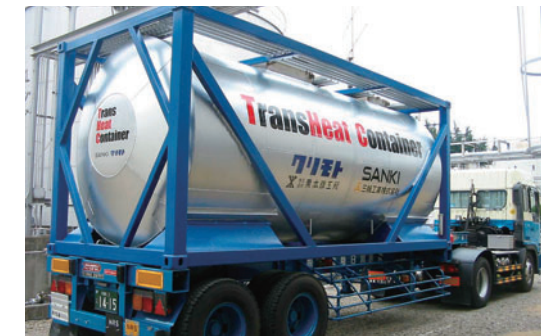
トラックで熱を運搬することで、遠隔地への熱供給が実現しました。
