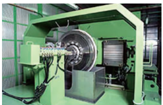
現在の新幹線車両走行スピードを遙かに上回り、苛酷な試験が行える試験機。
