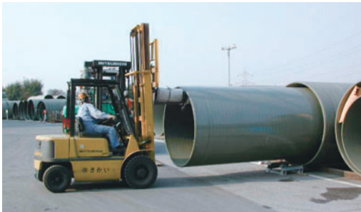
パイプ内にひとまわり小さいパイプを挿入し、運送するネスティングを実施。
