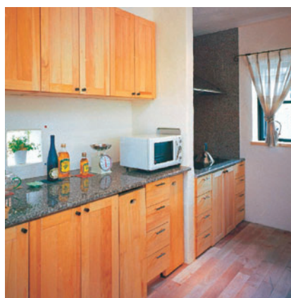
建具や床材は無垢の木材。接着剤は米のりやかわ、防腐剤に柿渋というように口に入れても安全な天然素材だけを使用しています。
